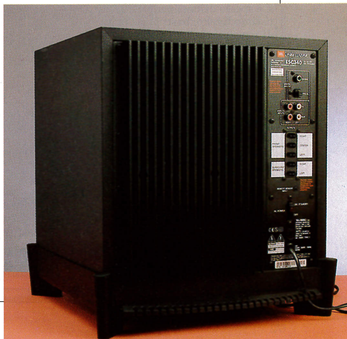
Il pannello comandi del subwoofer permette l'accesso alle funzioni principali del sistema.
