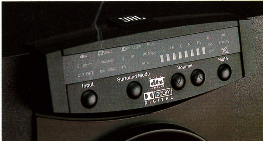
Il pannello comandi del subwoofer permette l'accesso alle funzioni principali del sistema.
